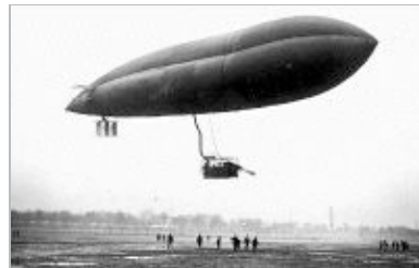
Dirigible. A diferencia de los Zeppelin, el de Torres Quevedo era flexible, más rápido y versátil.
